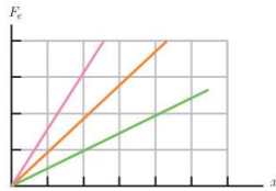
هرچه ثابت فنر بیشتر باشد، شیب نمودار بیشتر و فنر سخت تر است.
