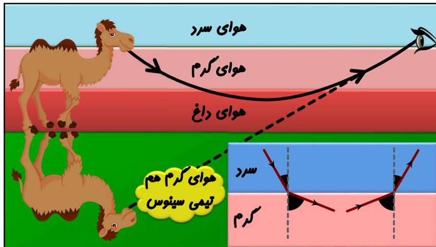
هر چی پایین تر میایم هوا گرمتر و چگالی آن کمتر می شود و ضریب شکست آن نیز کمتر می شود در نتیجه پرتو نور از خط عمود دور می شود و رفته رفته رو به بالا منحرف و به چشم می رسد و ما عس میکنیم آن عکس روی زمین افتاده
