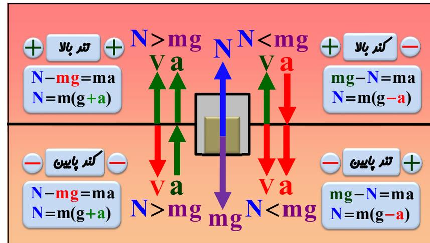
شخصی به جرم ۷۰ کیلوگرم درون آسانسوری قرار دارد در هر یک از حالات زیر **نیروی عمودی سطح** را حساب کنید.
