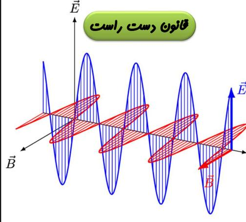
میدان های الکتریکی و مغناطیسی هر دو نوسانی هستند و بسامد و طول موج آن ها یکسانه
