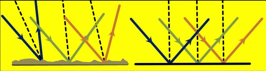
زاویه تابش با زاویه بازتاب همواره برابر است. در سطح غیر صیقلی زاویه تابش ها (زاویه پرتو تابش با خط عمود) برابر نیست
