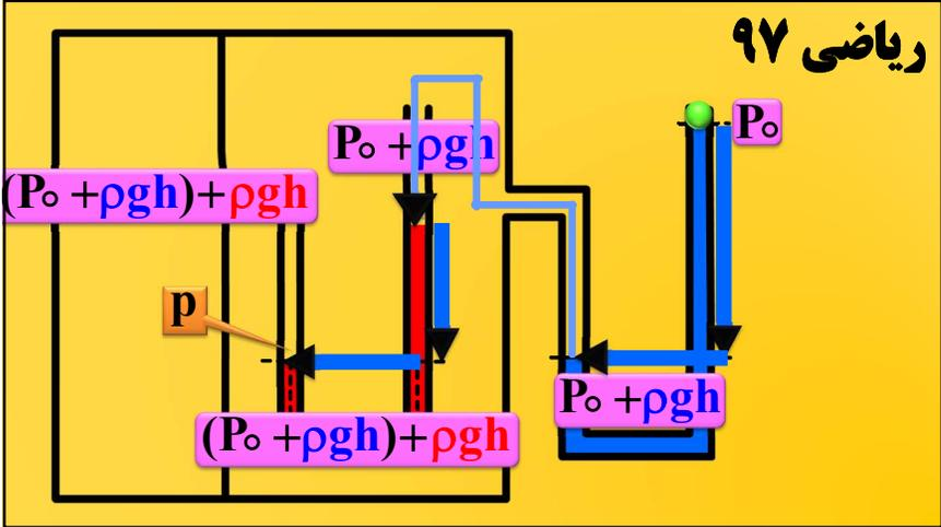
در شکل روبه‌رو، فشار پیمانه‌ای هوای درون ریه شخص که از شاخه سمت چپ لوله درون آن دمیده است، چند پاسکال است؟ (چگالی روغن  $800 \text{ kg/m}^3$  و چگالی آب  $1000 \text{ kg/m}^3$  است.)
